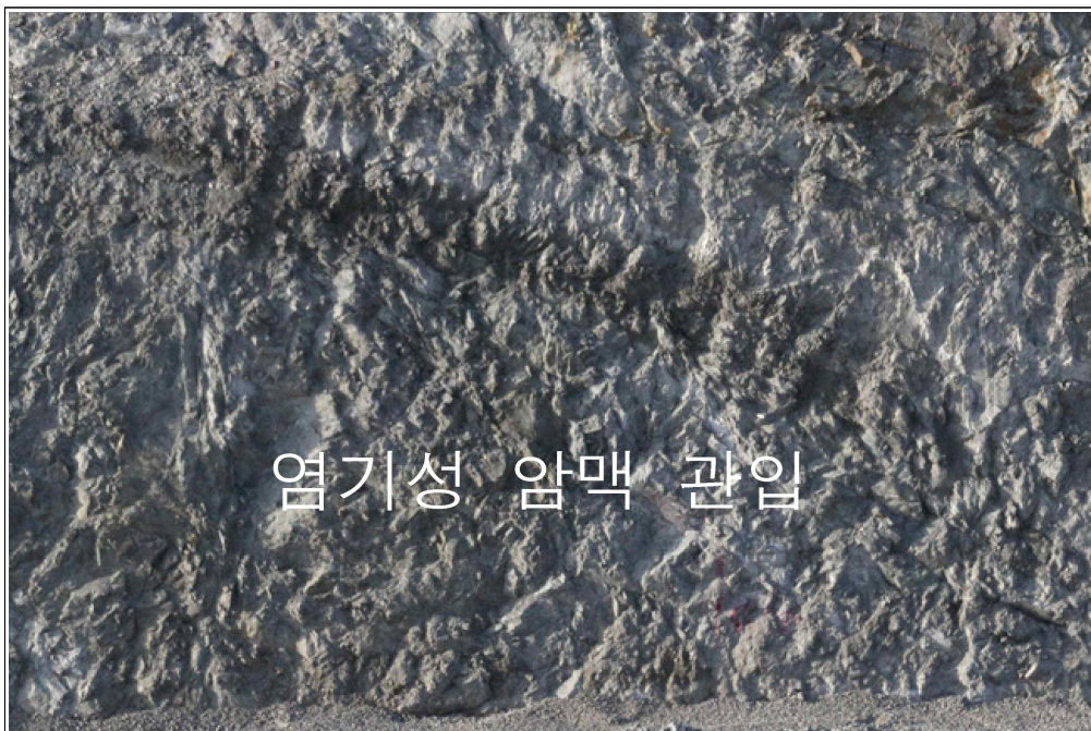
【그림 30】 C 영역 상세사진 (염기성 암맥 관입)
