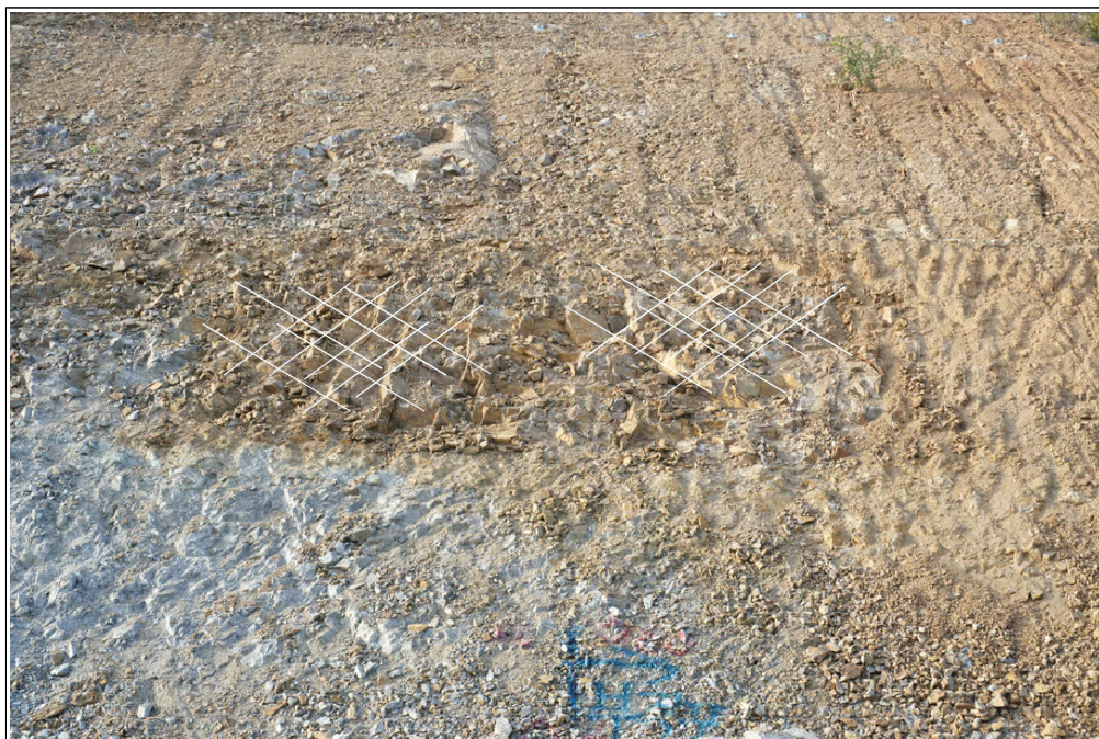
【그림 33】 D 영역 상세사진 (세편화된 암석)
